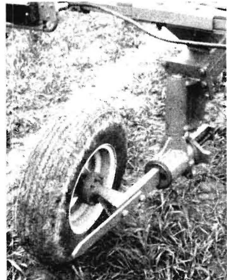
Bild 5. Kombiniertes Stütz- und Transportrad (Werkfotos)
