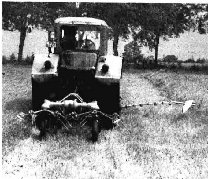
Bild 4. Rotorwender RW 2/200 in Kombination mit dem Seitenanbaudoppelmessermähwerk SMD 19 A
