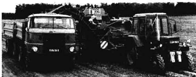
Bild 1 Fortschritt-Rodetrennlader E 686 im Einsatz
