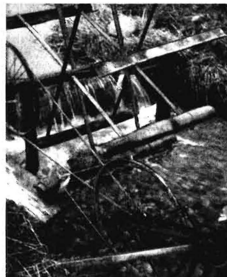
Bild 5. Ein Wasserrad im angestauten Bach trieb über ein Fahrradvorgelege einen Kleinspannungsgenerator an. Ein direkt mit der Welle des Wasserrades gekoppelter Autozündmagnet lieferte Induktionsstromstöße in die isolierte Leitung aus Gladdraht. Solche Stromquellen wurden vor allem im Bergland (Erzgebirge, Alpen) eingesetzt.
