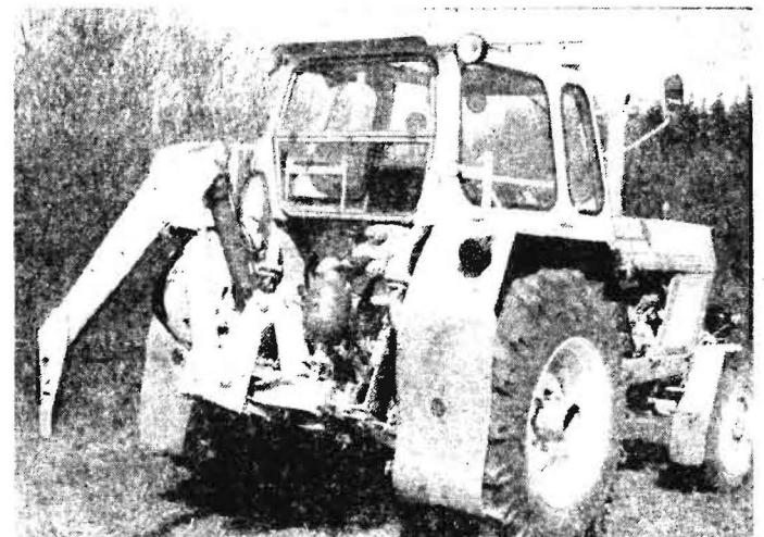
Bild 2. Krumenbasislockerer B246C mit hydraulischer Überlastsicherung in Transportstellung
