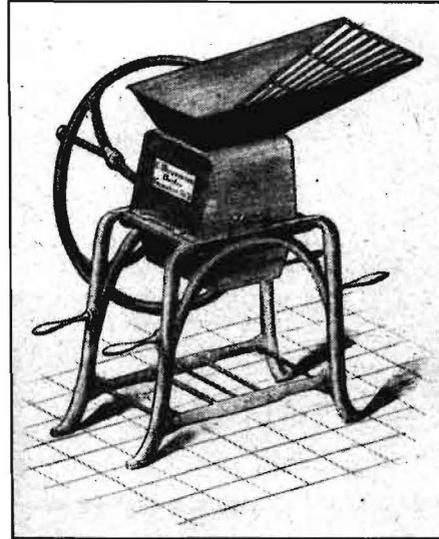
Bild 5. Schneidemaschine für Rüben und Kartoffeln nach Samuelson um 1850
