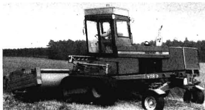
Bild 7. Schwadmäher E 303 mit Halbkette
