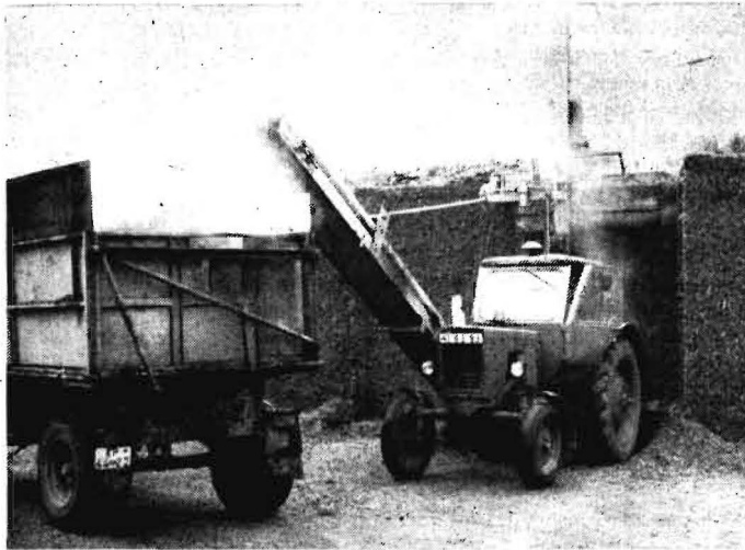
Bild 2. Forschungsmuster eines Anbaufräsladers für Traktoren (Massenstrom bei Maissilage 62 t/h in T.)
