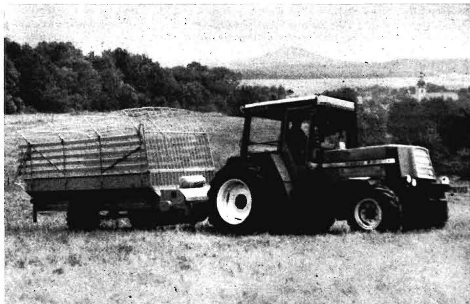
Bild 7. Futterladewagen HTS31.04 mit ZT325
