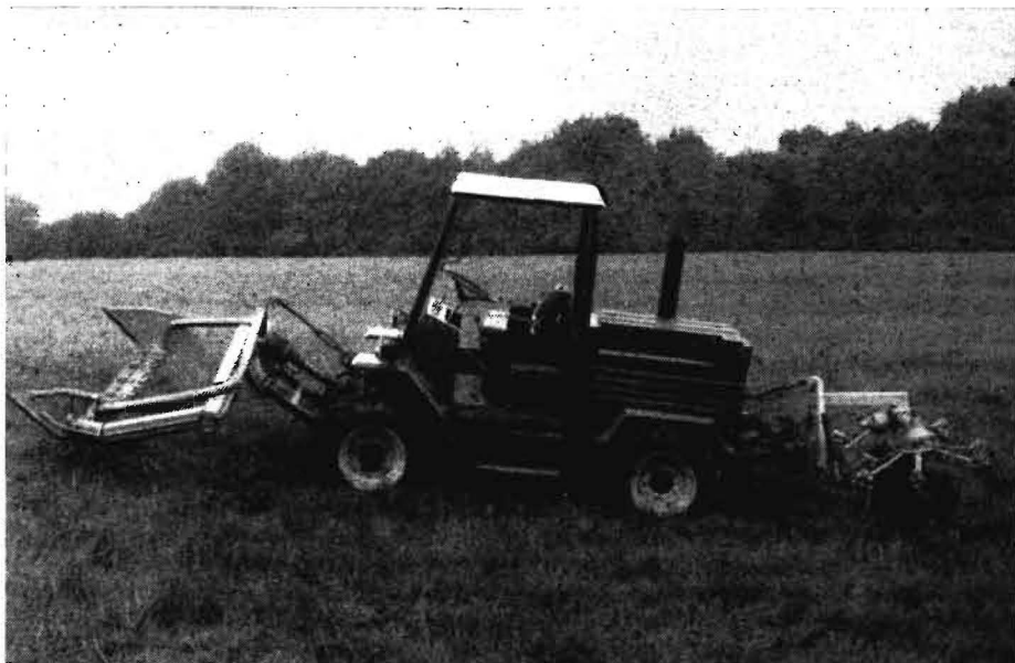
Bild 6 Mäh-, Wende- und Schwadmaschine MWS45 mit Doppel- messermähwerk und Rotorwender
