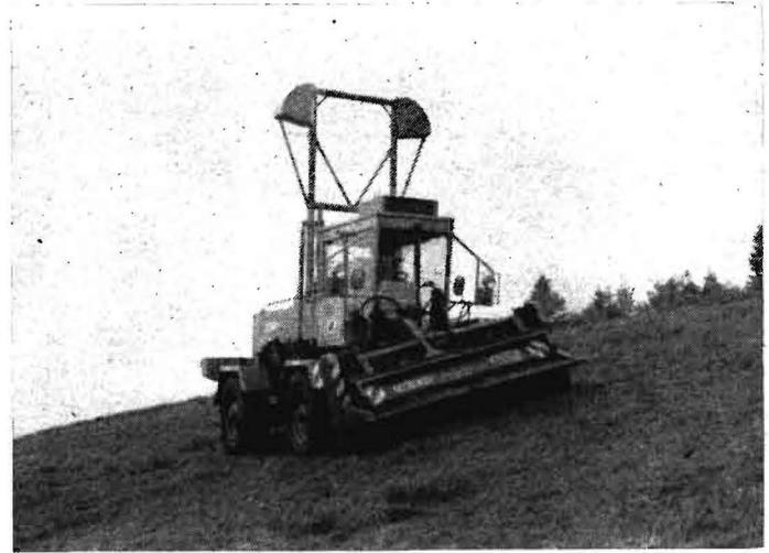
Bild 5. Geräteträger MT6-011 „Kabar-132“ mit hydraulisch schwenkbarem Fahrgestell. (Fotos: N. Hamke 2, B. Mross 3)
