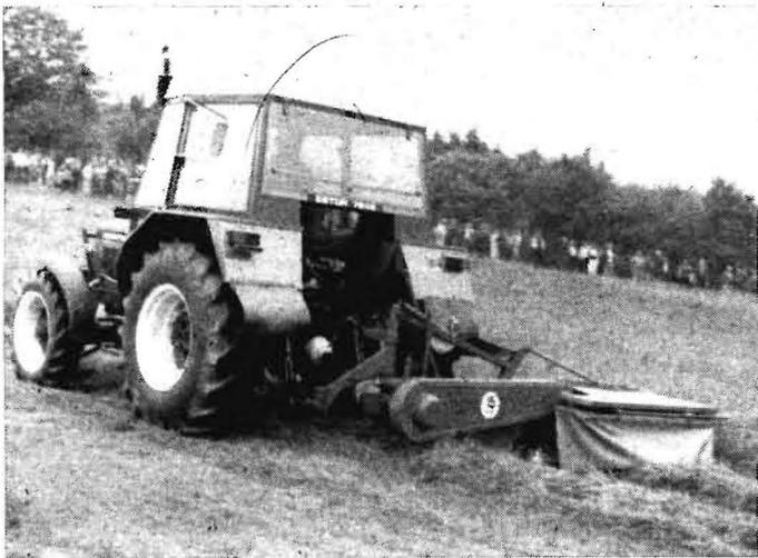
Bild 4. Zetor 7245 Horal mit Rotationsmäherwerk ŽTR-165H
