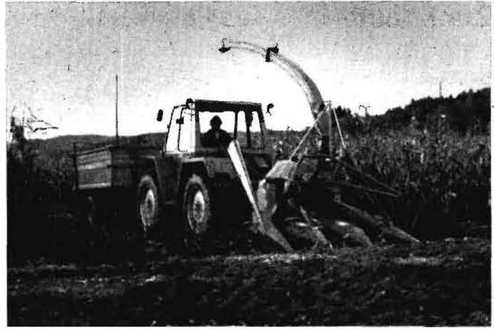
Bild 5. Allradtraktor 1014 (Zweiwegetraktor) der Kramer-Werke (BRD) mit dreireihigem Maishäcksler und Einachsanhänger
