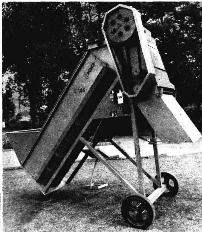
**Bild 16.** Rübenbröckler F 146/2 (VEB Landtechnischer Anlagenbau Schwerin); für die Zerkleinerung von Futterrüben und Zuckerrüben in der Rinderproduktion (kleine bis mittlere Tierkonzentrationen)
