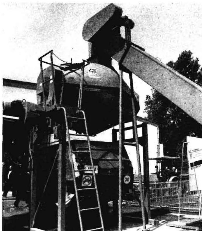
**Bild 19.** Futtermischer L421 A02 (VEB Landtechnische Industrieanlagen Kleinleipisch); zur periodischen Bereitung feuchtkrümeliger Futtermischungen in Schweineanlagen, Mindestdeckenhöhe der Futterhäuser 5000 mm, Futtermischung wird durch Momententladung an Verteilwagen übergeben
