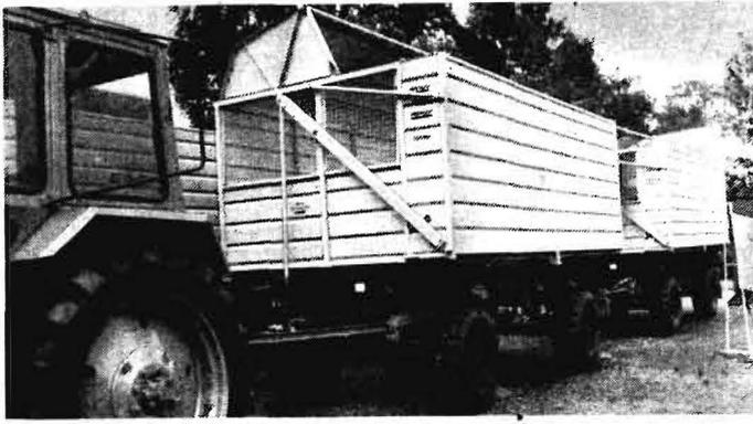
Bild 14. Einheitliches Aufbautensystem EAS für Anhänger HW60 (VEB Kombinat Landtechnik Cottbus); für den Transport aller Grobfuttermittel mit einer Schüttdichte bis 600 kg/m<sup>3</sup>, d. h. auch für Ballen- und Häckselstroh, zur Vermeidung von Übergabeverlusten von der Erntemaschine mit kombiniertem Überblasschutz ausgerüstet
