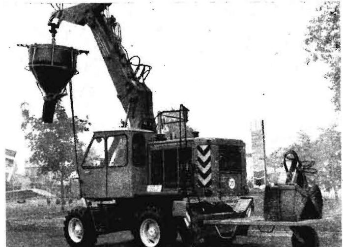
Bild 3. Mobilkran T174/2 mit Beladearmatur, Nachläufer und Zusatzausleger (Foto: G. Hammer)
