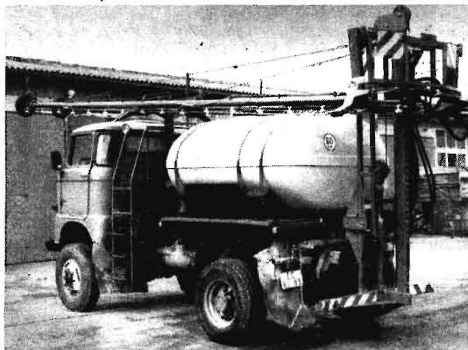
Bild 2. Aufbauflanzenschutzmaschine Kertitox Global-M auf LKW W50 mit Spurverbreiterung
