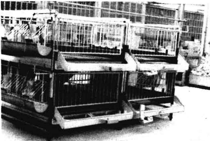
Bild 1. Versuchsmuster einer instandsetzungsgerechten GAZ-Käfigbatterie (Zwischen- und Rückwand sind symmetrisch gestaltet, so daß sie nach ihrem Verschleiß im unteren Bereich gedreht werden können; korrosionsgefährdete Flächen mit einem zusätzlichen Bitumenanstrich versehen)
