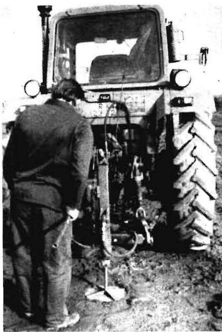
Bild 3. Kalibrierung der Meßgeber im Boden (Fotos: G. Kotte)
