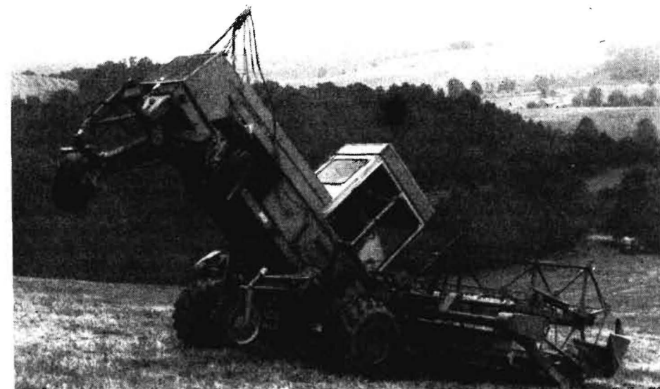
Bild 6. Extreme Fahrerprobung des Schwadmähers E 303 am Hang
