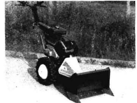
Bild 2. Dungschieber A58; technische Daten: Masse 15 kg, Arbeitsbreite 600 mm, Schildhöhe 360 mm, Arbeitsgeschwindigkeit 2. Gang
