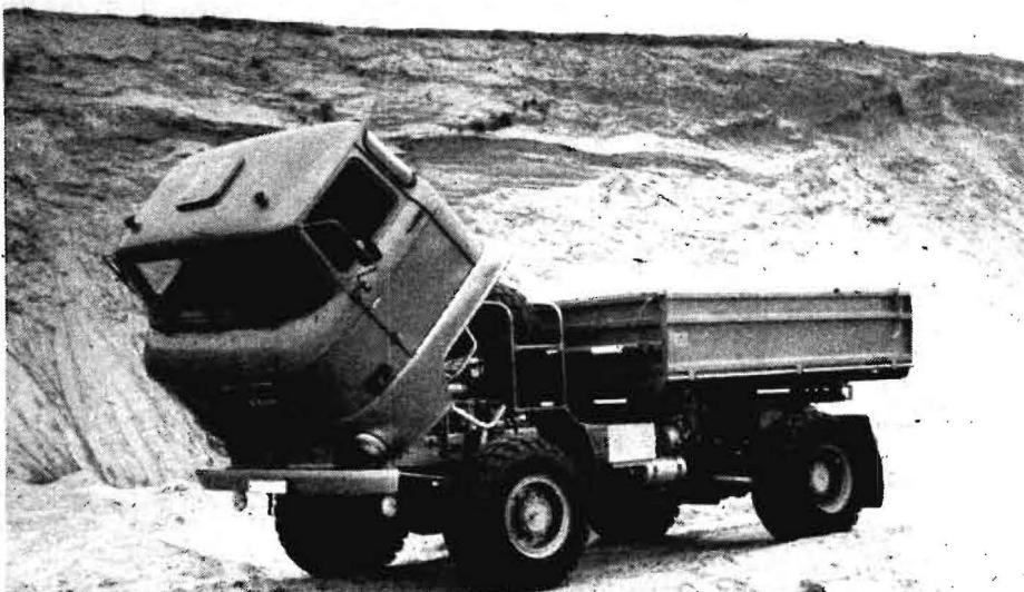
Bild 13. Angekipptes Fahrerhaus des IFA L60 (Variante mit Dreiseitenkippaufbau und Bereifung 18-20)
