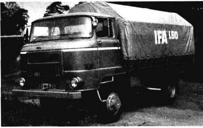
Bild 1 Der neue Nutzkraftwagen IFA L60 1218 4 x 4 mit Stahlpritsche und Plane
