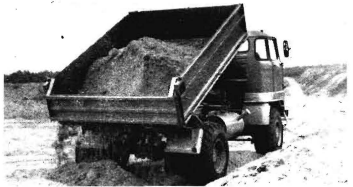
Bild 16. IFA L60 mit Dreiseitenkippaufbau und Niederdruckbereifung 18-20
