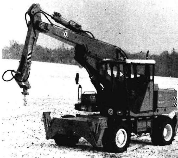
Bild 3. Mobilkran-Mobilbagger T 188-A04 mit Abstützung an der Hinter- und Vorderachse
