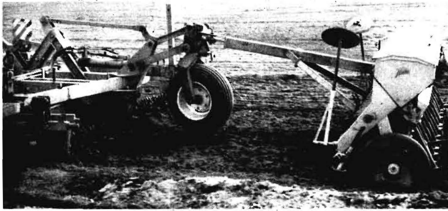
Bild 2. Zur Anhängung an das Saatbettbereitungsgerät B601 umgerüstete Drillmaschine A201
