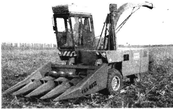
Bild 6. Feldhäcksler E281 C mit Maiskolbenpflücker
