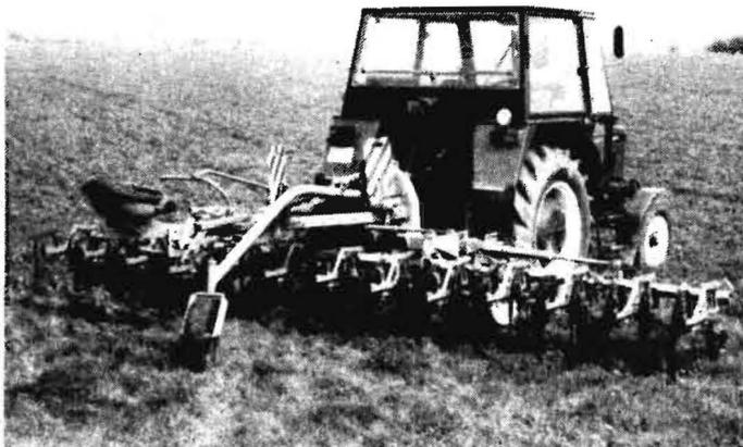
Bild 2. Heckanbau-Vielfachgerät P 440 mit Häufelausrüstung und Spurreißer-einrichtung (Fotos: M. Bräunlich)
