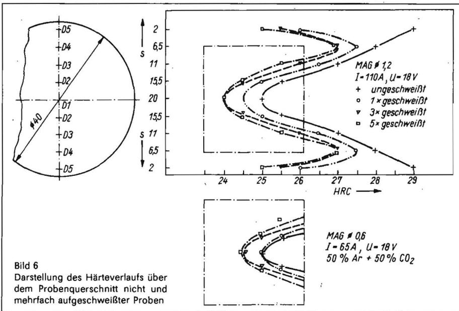
Bild 6 Darstellung des Härteverlaufs über dem Probenquerschnitt nicht und mehrfach aufgeschweißter Proben
