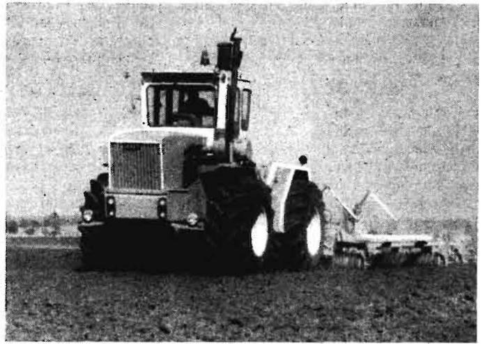
Bild 9. Traktor Rába 300, mit breiten Reifen 30,5-32 ausgerüstet
