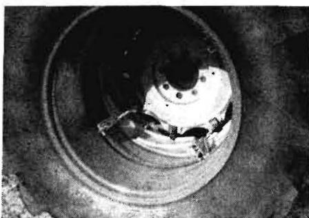
Bild 6. Radkupplung, System HD, der Gebr. Schaad AG zur Schnellmontage von Zwillingrädern
