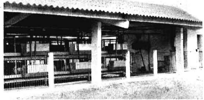
Bild 2. GAZ-Batterie aus DDR-Produktion in kubanischem Typenstall, Fütterungs- und Entmistungstechnik nach 4 Einsatzjahren mit Handschaltung voll einsatzfähig
