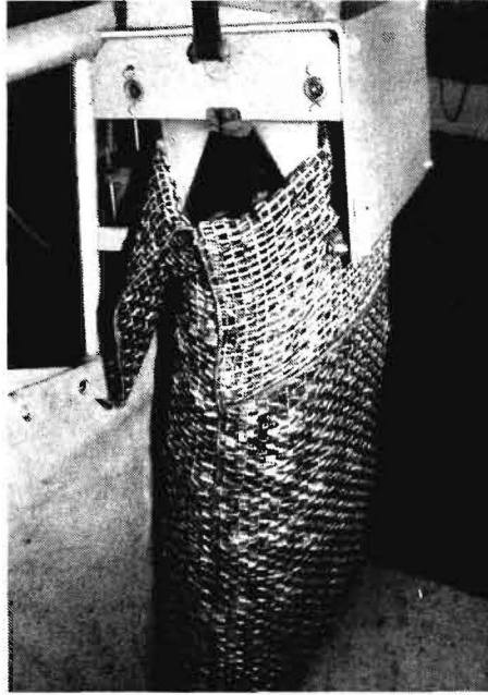
Bild 2. Klappensack aus Versuchsmaterial in der Sackhaltevorrichtung der Absackwaage K961/S
