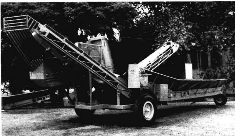
Der im Bild dargestellte Rübenbröckler RB 12 mit Steintrenneinrichtung (RB 12 St/K) ist ein Versuchsmuster, das mit guten Ergebnissen in den LPG (T) Warin und Brüsewitz (beide Bezirk Schwerin) zum Einsatz kam.
