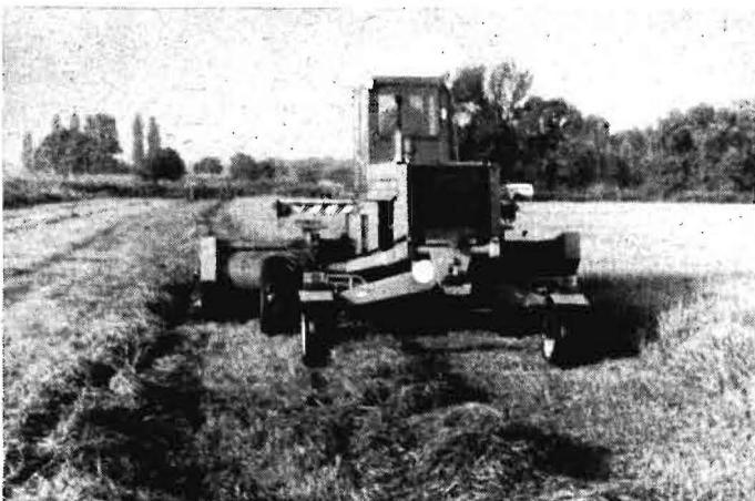
Bild 3. Feldhäcksler E281 mit Breitaufnehmer SAN42 bei der Aufnahme von Doppelschwaden
