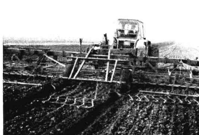
Bild 5. Kopplungswagen T890 mit Löfflegge und kombinierter Saatlegge B321 bei der Saatbettbereitung
