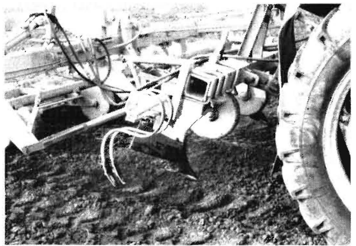
Bild 7 Spurenlockerer hinter den äußeren und Häufelkörper hinter den inneren Hinter- rädern des ZT 303 zur Vormarkierung der Spur für den stab- ilen Lauf des Kopplungswagens T 890
