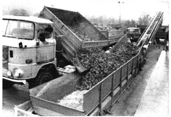
Bild 2. LKW-Anhänger-Zug beim Abkippen in den Annahmeförderer
