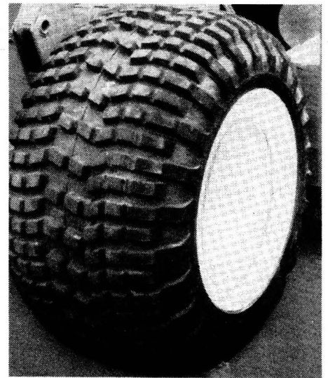
Bild 2. Bodenschonender Breitreifen für die Antriebsräder des Schwadmähers „Slawjanka“
