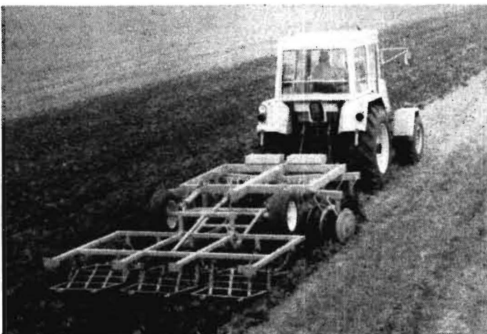
Bild 5. Scheibenegge B402 mit Eggenträger
