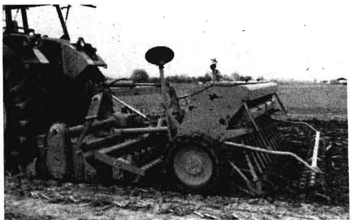
Bild 2. Bodenfräse der Fa. Rau mit angehängter Sämaschine, zur pfluglosen Bestellung geeignet
