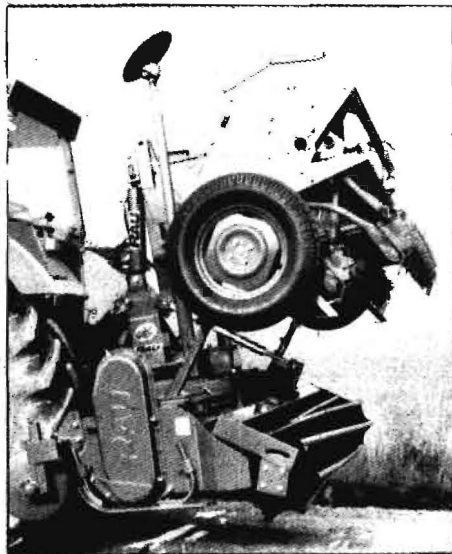
Bild 3 Transportstellung der Gerätekombination Rototiller-Sämaschine
