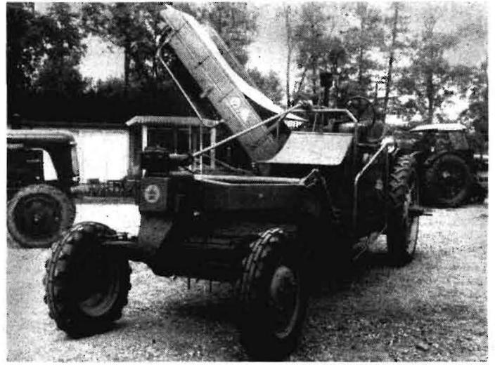
Bild 4. Auflader für Rübenkraut T273 im Geräteträger RS08/15 „Maulwurf“
