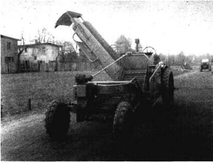
Bild 3. Auflader für Rüben T271 im Geräteträger RS08/15 „Maulwurf“
