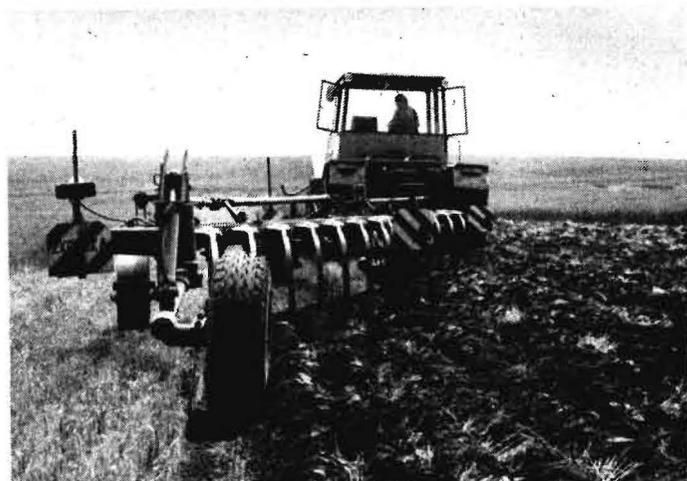
Bild 2. Unsymmetrischer Scheibenschälflug PH 2-020 (ČSSR); Arbeitsbreite 350 cm, max. Arbeitstiefe 15 cm, Masse 3480 kg
