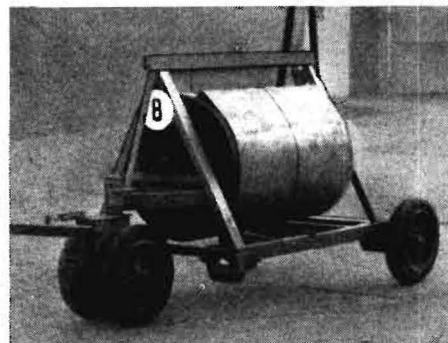
Bild 7. Seilwinde in Transportstellung
