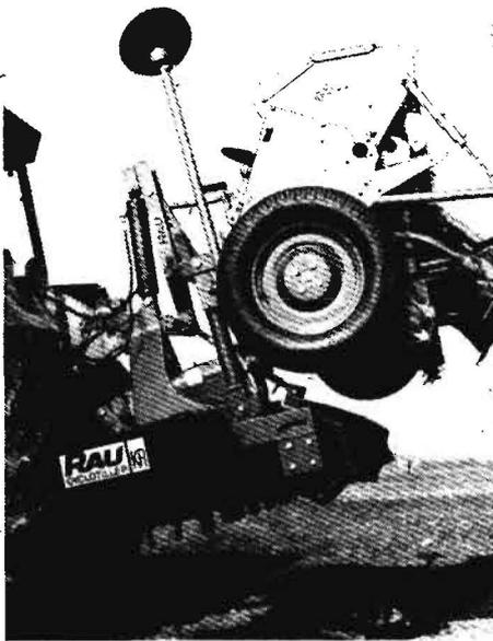
Bild 2. Kreiselegge mit in Transportstellung hochgeklappter Drillmaschine (Fa. Rau, BRD)
