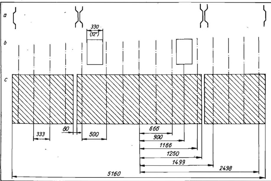
Bild 3. Verlagerung der Werkzeugsektionen im B620 zur Saatbettbereitung in Regelspuren beim Raps;
