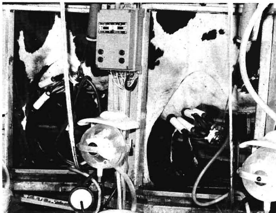
Bild 1. Teil des Melkkarussells M 500 mit SPM 02 A, Nachmelk- und Abnahmeroboter und Kippschalenmeßwertgeber
