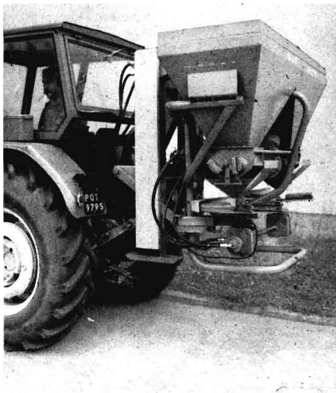
Bild 2 Anbaustreuer mit Hub-einrichtung; Nutz-masse 400 kg, zur Aus-bringung großer und kleiner Gaben, Arbeits-breiten von 12 m und 18 m, hydraulisch an-getriebene Zweischei-ben-Streueinrichtung kann auf eine Höhe von 1,8 m über den Boden angehoben werden
