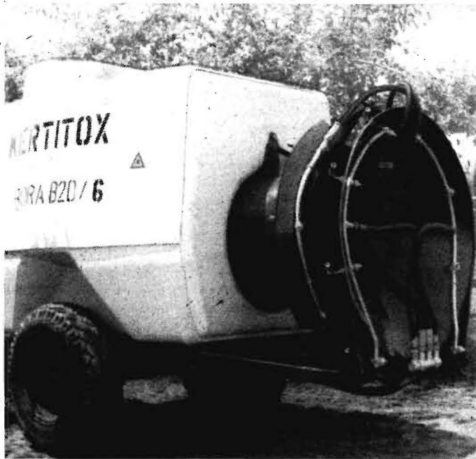
Tafel 2. Mit der Maschine Bóra B-20 in Obstplantagen erreichter Bedeckungsgrad (Brühemenge 800 dm 3 /ha, Arbeitsgeschwindigkeit 10,5 km/h, Betriebsdruck 2,5 MPa)
