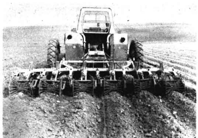
Bild 4 Kombinationspflegegerät KPF-K6 im Rüstzustand Lockern – Häufeln – Dammoberflächenbearbeitung mit Stabwalzenkrümmler
