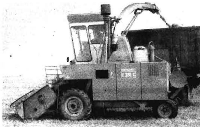
Bild 1 Feldhäcksler E 281 mit angebauter Dosierein- richtung im Feldeinsatz
