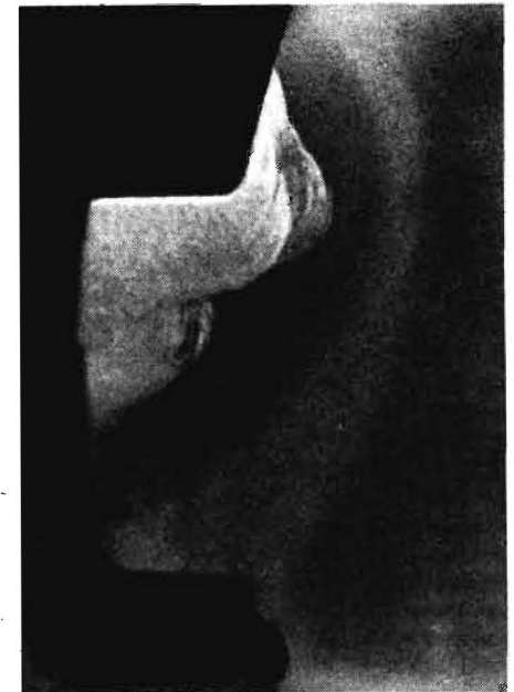
Bild 5. Keilprofil, geschweißt mit Wärmeeinflußzonen (Vergrößerung 4:1)
