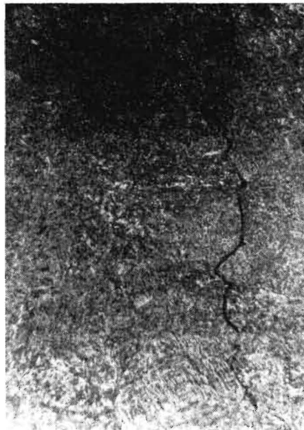
Bild 4. Martensit mit Härteriß (Vergrößerung 200:1)
