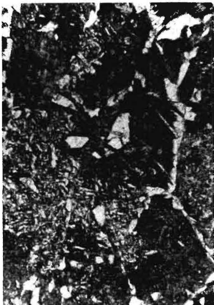
Bild 3. Stengelförmige bainitische Kristallite mit ferritischer Korngrenzsubstanz (Werkstoff 30MnCrTi5, Vergrößerung 500:1)
