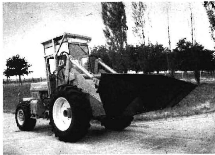
Bild 4. Forschungsmuster des Frontschaufelladers FSL 1500 auf der Basis des Traktors ZT 303 (Fotos: G. Kotte)
