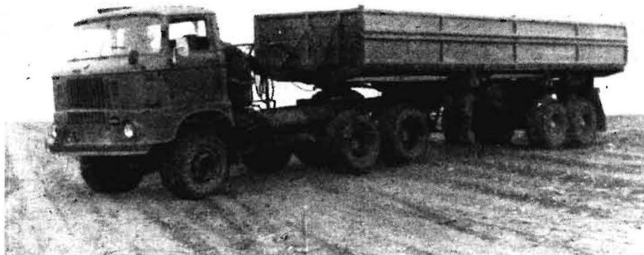
Bild 9. Versuchs-LKW (6 x 6) des VEB Automobilwerke Ludwigsfelde mit Seitenkippsattelaufleger [2]
