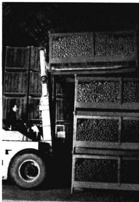
Bild 2. Behältereinstapelung mit dem Gabelstapler DFG 6302 HGE
