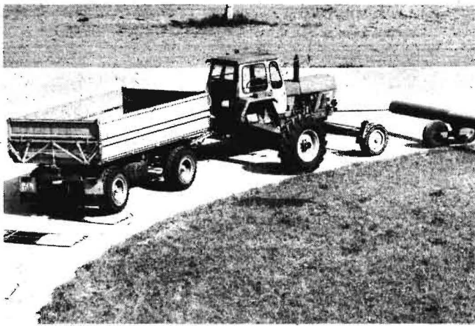
Bild 3. Rundlaufprüfbahn mit Antriebsaggregat
