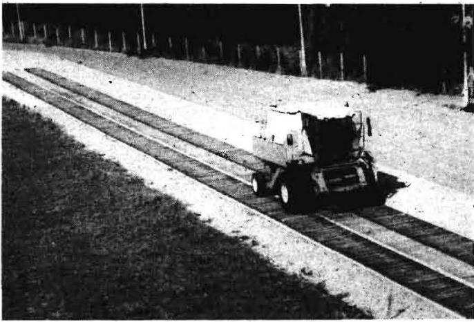
Bild 5. Prüfbahn für Schwingungsuntersuchungen
