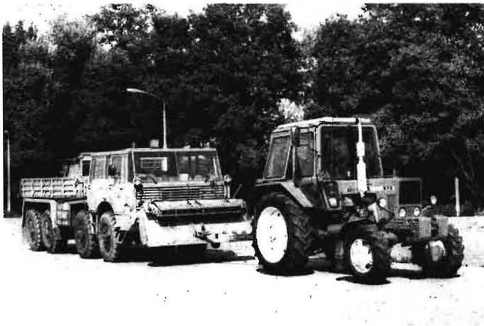
Bild 1. Belastungsmittel (Bremsfahrzeug) für Zugkraftmessungen auf Basis des NKW Tatra 813
